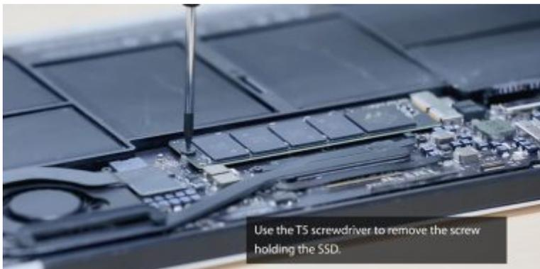
用 T5 螺絲起子轉開鎖住固態硬碟的螺絲。
