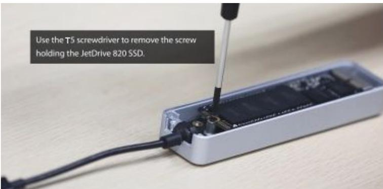
用 T5 螺絲起子轉開鎖住 JetDrive 固態硬碟的螺絲。
