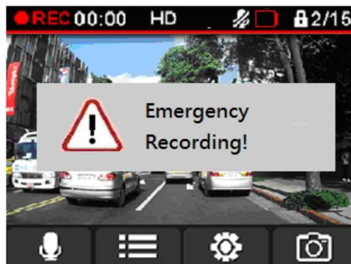
**G-Sensor Notfall-Aufnahme:** Wenn die DrivePro während der Aufzeichnung einen Aufprall feststellt, aktiviert die Kamera mit dieser Einstellung automatisch den Notfall Aufnahmemodus.
